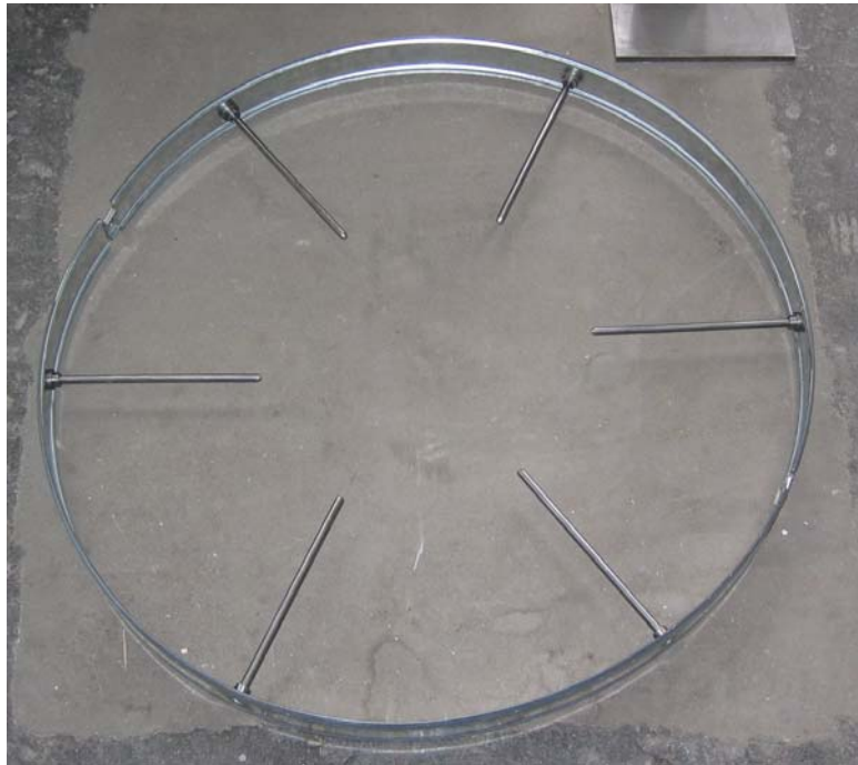
Bild 2: Verzinkter Stützring aus Stahlblech mit fünf montierten ferritischen Abstandshaltern
