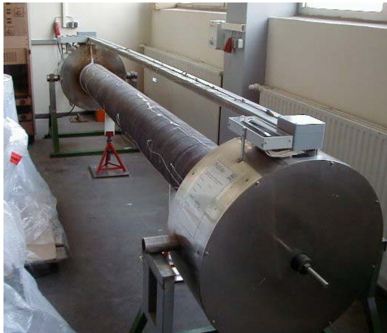
Bild 3: Prüfrohr \varnothing 324 mm mit Schutzzylinder und Stirnheizungen
