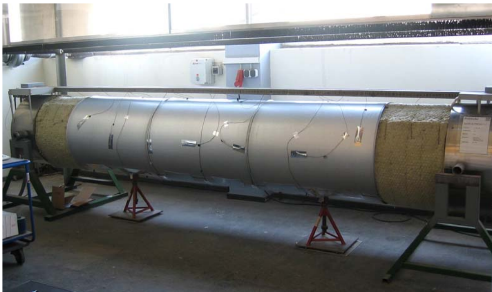
Bild 6: Versuchsaufbau des Prüfrohrs mit Dämmung aus Mineralwolle und Ummantelungsblechen (oben: geöffnete Haube aus Plexiglas)
